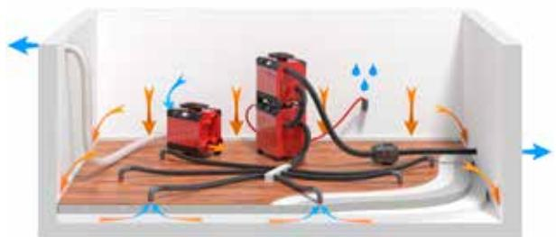
En turbin som sugetørker en gulvkonstruksjon med vannutskiller og kombifilter.
