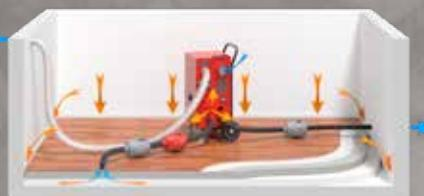
Sugetørking skal alltid benyttes som et første trinn ved tørking av flytende gulv på betonplate, der det har lekket vann ned i fyllingen eller isolasjonen under det flytende gulvet.
