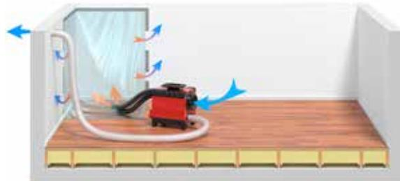
Optimaliser tørreresultatet med grundig innlukking i plast.
