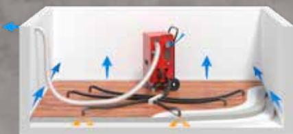
Trykktørking er en av markedets raskeste og mest effektive metoder for tørking av lagdelte konstruksjoner.
