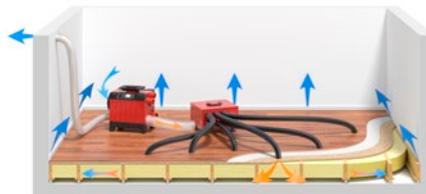
**Tørking av isolasjon i bjelkelag.** En av de mest effektive måtene å tørke isolasjon i et bjelkelag eller en lektet konstruksjon på, er å bruke både en lavtrykksvifte og en avfukter.
