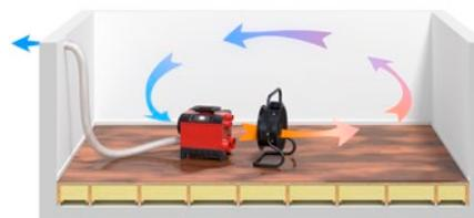
**Romavfukting.** Avfukteren blåser tørrluft fritt ut i hele rommet, slik at samtlige overflater tørkes. For å øke luftomsetningen og påskynde tørkeprosessen kan med fordel en vifte av typen AX3000 benyttes.
