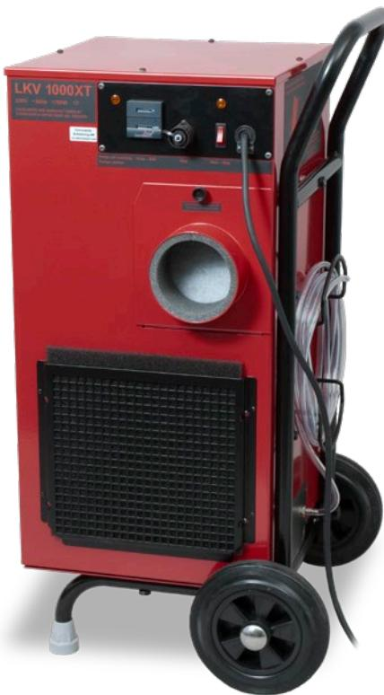
Maskinen pumper automatisk ut kondensvannet, med en maksimal pumpehøyde på fire meter. Den avfukter også ved lave temperaturer og tilfører rommet ca. 3 kW varme ved drift til tross for et energiforbruk på bare 1,7 kW. CTR LKV 1000XT har en kapasitet på 20 l/døgn.
